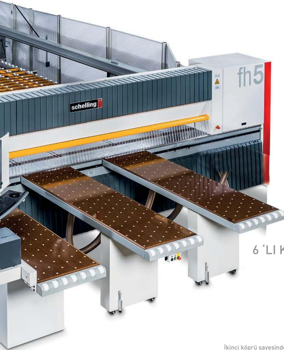
FH 5 birçok otomatik monitör kontrollü fonksiyona sahip karakterdedir. Bu sayede ahenk içinde optimize edilmiş ardışık operasyonlar sağlanmıştır. Kesilecek malzemenin yüksekliği dahi özel entegre sensörler ile işleme tabi tutulur. Testere hareketleri minimize edilir ve üretimde zaman azaltılır. Testere arabası hızı, kesim hızına göre otomatik ayarlanır. Ayrıca kesilecek malzemenin cinsine ve yüksekliğine göre üst baskı basıncı kendinden ayarlanır.
