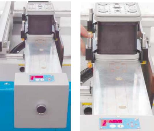
Konsolda 8 adete kadar Schmalz marka vakum podu dizilme imkanı.
